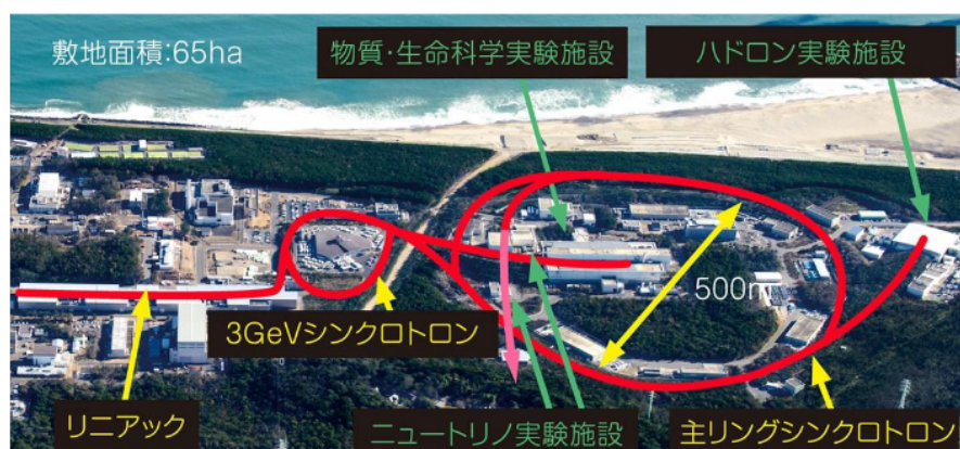
図 2.1: J-PARC の加速器施設と実験施設 [33]
